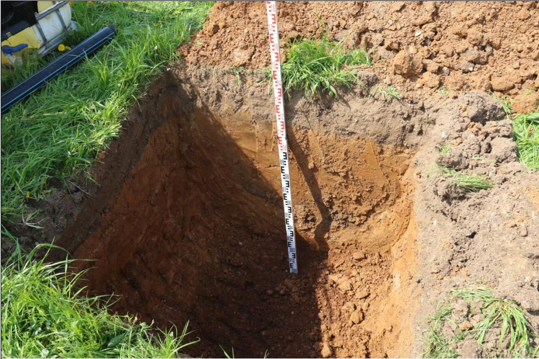
**Foto 3:** Schürfgrube für den Versickerungsversuch
