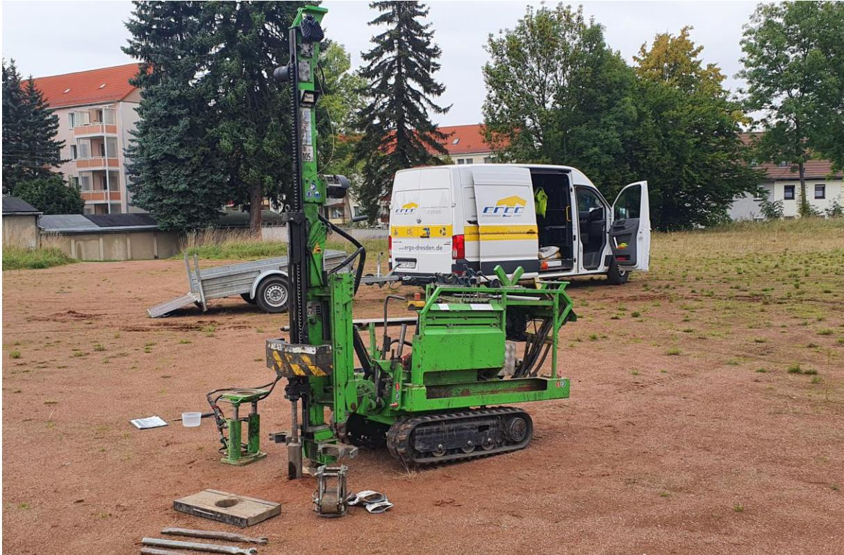
**Abbildung 1** Bohrgerät zur Kleinrammbohrung
